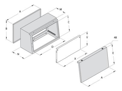
Note: per il collegamento con mensola è obbligatorio il pannello LMC.../C onde evitare la collisione fra pannello anteriore e pannello mensola.
